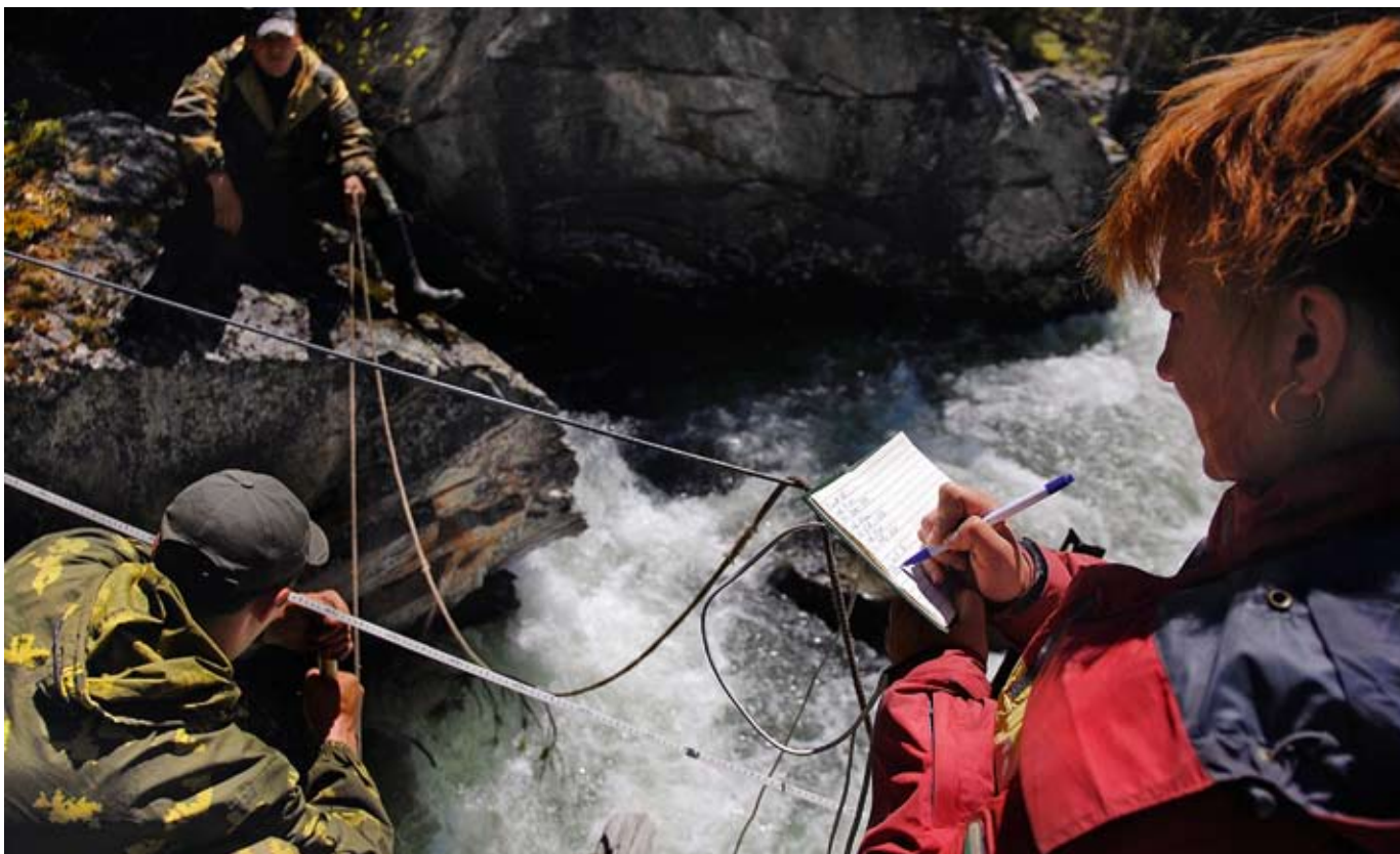
Замер скорости течения в реке Осиновка (вверху). Такие измерения позволяют выявить динамику таяния ледников Алтая. Наблюдение за животными и их учет (внизу) – важная часть работы инспекторов Катунского заповедника
